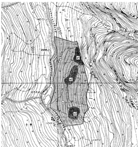
Ambito territoriale estrattivo B6 ATE3 nel comune di Aprica, con le aree estrattive (a1 e a2).
